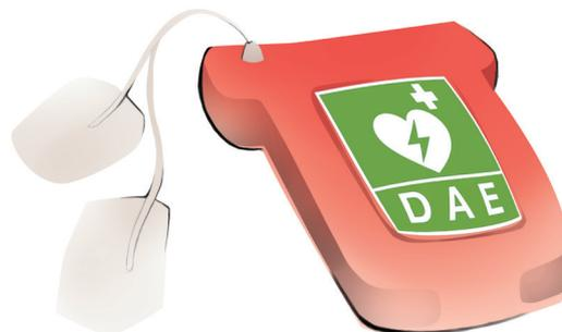
L’accensione del DAE si esegue tramite il tasto di accensione; in alcuni modelli, questo tasto è sostituito dall’apertura dello sportello. I DAE funzionano con batterie a lunga durata, generalmente non ricaricabili e da sostituire alla scadenza.
